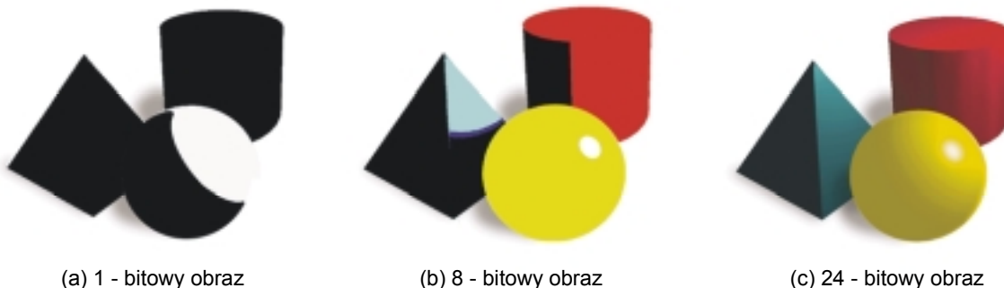
Rys. 1 Jakość wyświetlanego obrazu jest funkcją ilości bitów użytych do opisu pojedynczego piksela.
